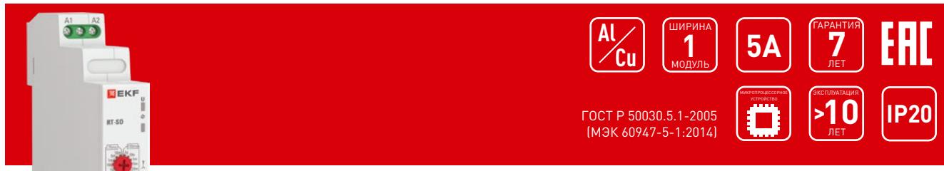
Реле времени RT-SD EKF изготовлено на базе микроконтроллера, является электронным коммутационным аппаратом запуска электродвигателя способом «звезда-треугольник». Такой способ запуска двигателя позволяет снизить пусковые токи двигателя, создать более плавный пуск и тем самым продлить срок его службы.
