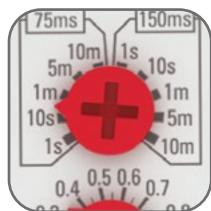
Возможность регулировки предустановки интервала задержки выключения режима «звезда»
