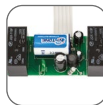
Два встроенных реле на токи до 16 А
