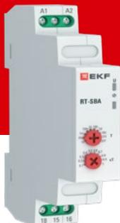
Реле времени RT-SBA EKF является электронным коммутационным аппаратом с регулируемой установкой времени, работающим на включение. Переключение диапазона времени производится с помощью поворотного регулятора, расположенного на лицевой поверхности реле.
